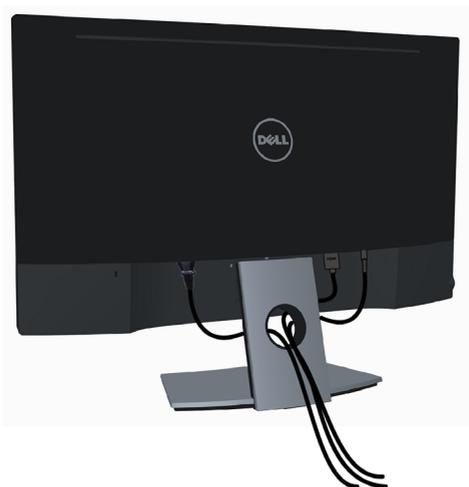
Setelah menyambungkan semua kabel yang diperlukan ke monitor dan komputer, (baca [Menyambungkan Monitor](#) Anda untuk pemasangan kabel) atur semua kabel sebagaimana ditunjukkan di atas.
